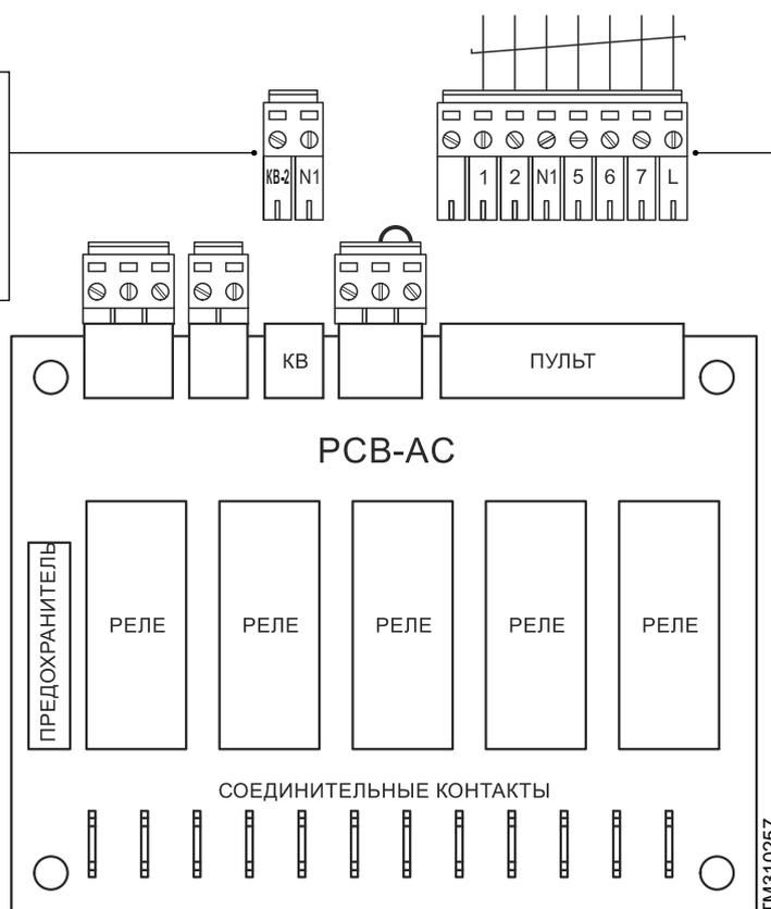
**Разъём пульта:** Разъём для подключения пульта управления к завесе.
