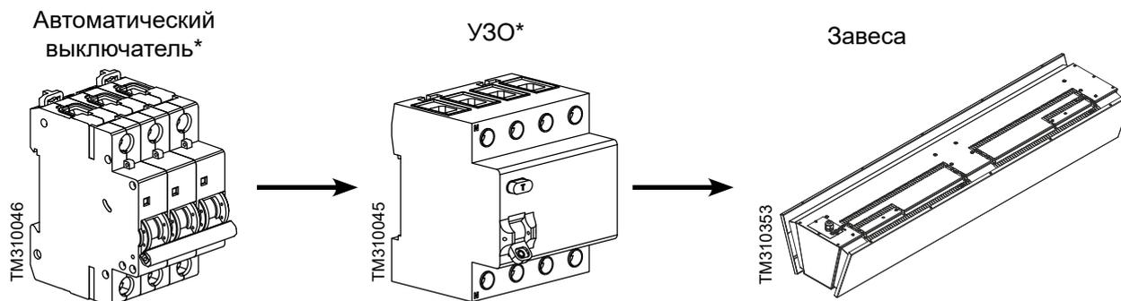
\* На рисунке изображены трёхполюсный автоматический выключатель и четырёхполюсное УЗО для подключения трёхфазной завесы. Принцип подключения однофазной завесы остаётся таким же, только вместо трёхполюсного автоматического выключателя используется двухполюсный и двухполюсное УЗО.
