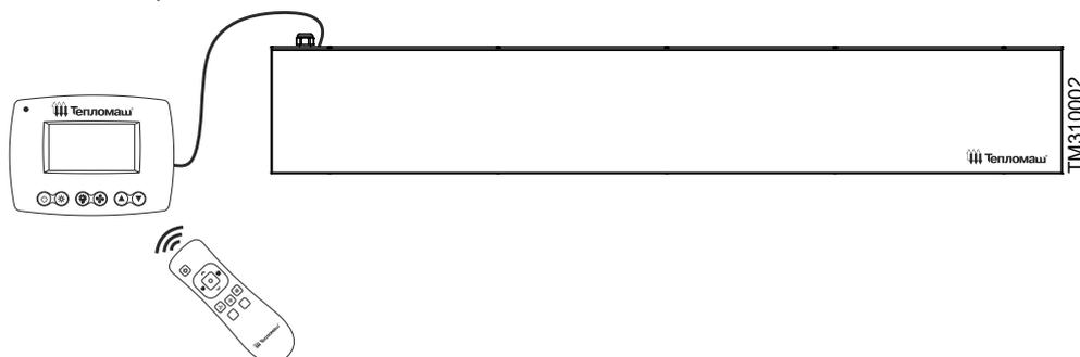
Конструкция воздушно-тепловых завес может состоять из одного вентиляторного блока или нескольких в зависимости от их длины, серии и модели. Завесы с условной длиной 1 метр включают один вентиляторный блок, 1,5 и 2 метра - два вентиляторных блока и 2,5 метра - три вентиляторных блока.
